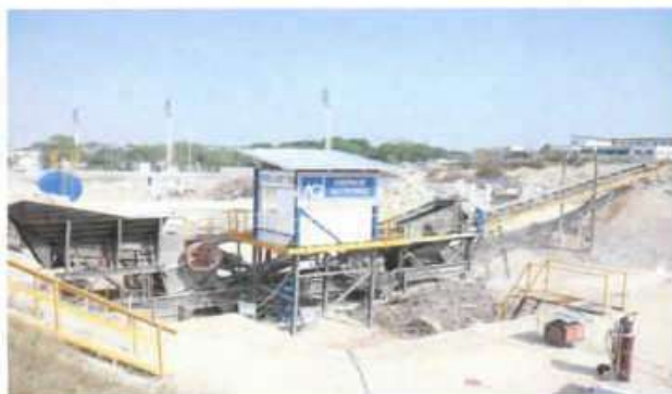
Foto 13: Britagem do Material Demolido para Reaproveitamento
